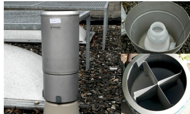
GeoZentrum GNIP sampler
